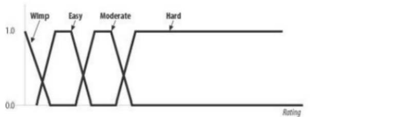
trapézoidy jsou nejčastější z důvodu jednoduchosti, používají se ale i sigmoidy
